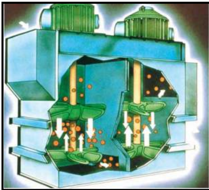
Slika 5 Prikaz rada atricijskog skrubera (Izvor: http://www.metso.com )
